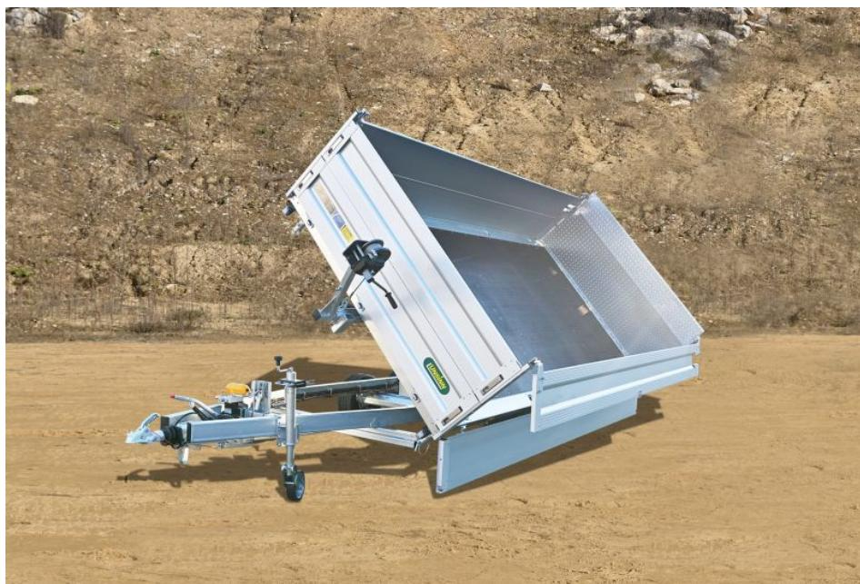
Der Maschinentransporter-Zweiseitenkipper Typ »DUO« von UNSINN ist ein Pritschenhochlader mit nach hinten kippbarer Ladefläche und ein Seitenkipper zugleich. Das macht ihn zu einem echten Allrounder (Bild: Unsinn).
