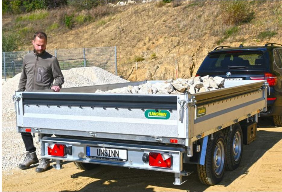
Der neue Dreiseitenkipper Typ »UDK-S« mit Stahlbordwand sowie integrierter Netz- und Planenleiste ist für härteste Einsätze konzipiert (Bild: Unsinn).
