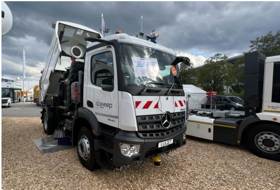
Faun präsentierte mit »a.sweep« das Konzept einer automatisiert fahrenden Straßenkehrmaschine auf der IFAT 2022 (Bild: Faun).
