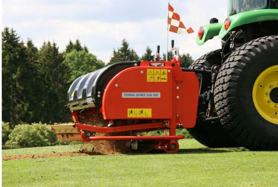
Zur Tiefenbelüftung und Beseitigung von Verdichtungen bis in 25 cm Tiefe: »Terra Spike GXi 8 HD« von Wiedenmann (Bild: Wiedenmann).
