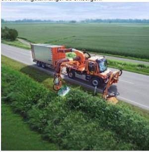
Unimog »U 530« und Mähgutanhänger mit Mulag »ECO«-Mähtechnologie für schonende Grünstreifenpflege (Bild: Daimler Truck).
