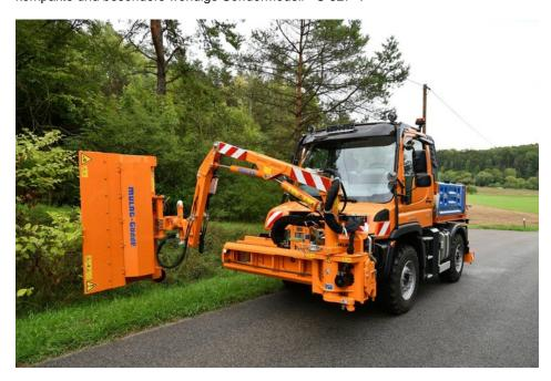
Unimog »U 219« mit Sommer- und Winterdienstkombination, Mulag Heckenschneider und Bucher Streuautomat »Yeti W16« (Bild: Daimler Truck).
