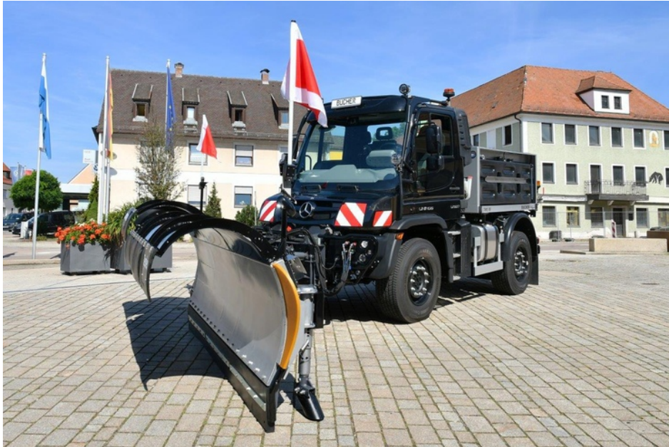
Unimog »U 327« mit ECO-Winterdiensttechnologie von Bucher Municipal, Streuautomat »Yeti W20o« und teleskopierbarer Schneepflug »Teplex TE90.30/40S« (Bild: Daimler Truck).
