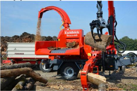
Ein »Biber 60 « im Einsatz. Vorne rechts ist ein zusätzlicher »Spaltbiber 700 « mit einem Ablagedurchmesser von 70 cm angebracht (Bild: Eschlböck).
