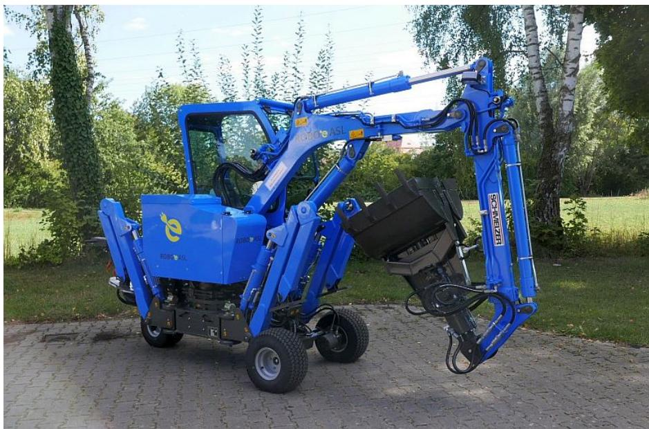
Der neue Grabbagger hat 2 Fahrstufen oder ist per Anhänger auf öffentlichen Wegen umsetzbar (Bild: Schmelzer).
