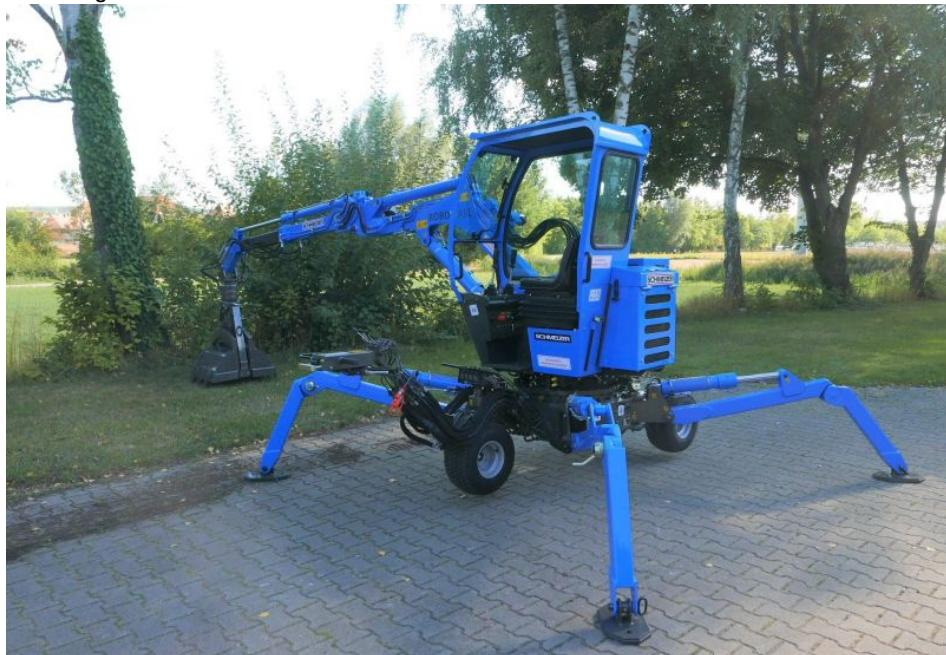
Neu im Programm der Grabbager von Hermann Schmelzer – der vollelektrische »ROBOe-ASL« (Bild: Schmelzer).
