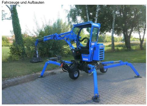
Neu im Programm der Grabbager von Hermann Schmelzer – der vollelektrische »ROBOe-ASL« (Bild: Schmelzer).
