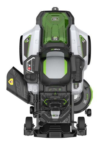
Der Fahrer sitzt nahe am Ort des Geschehens auf einem vielfach einstellbaren, hydraulisch gefederten Sitz mit komfortablen Armlehnen (Bild EGO).
