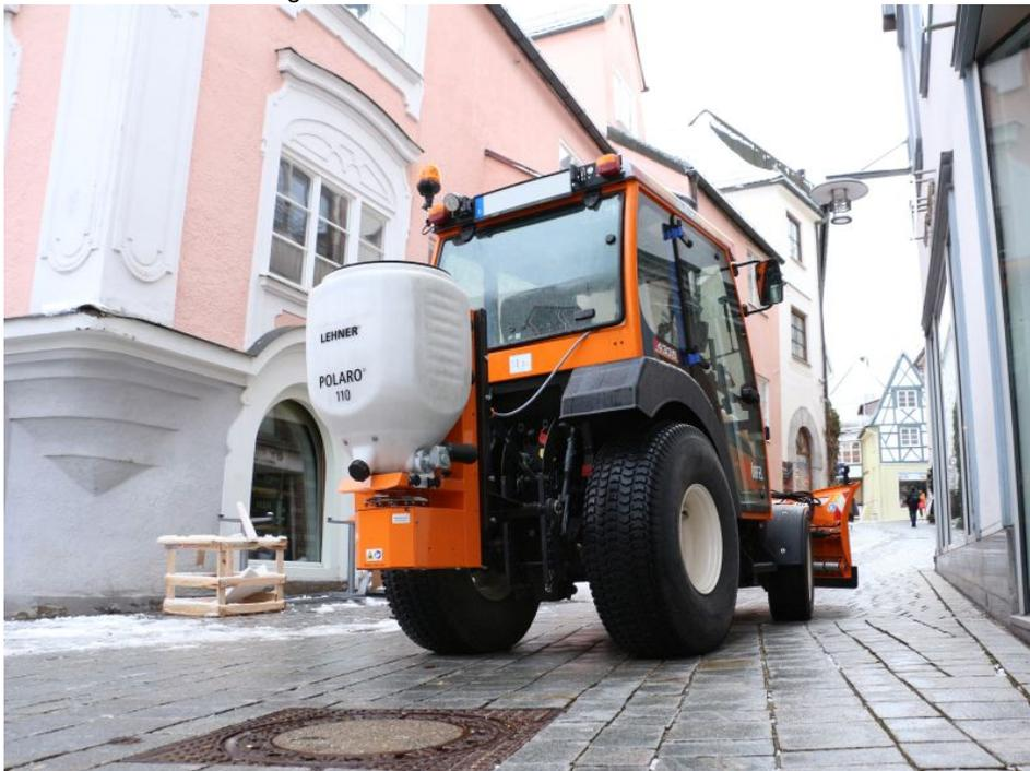
12V-Streuer »Polaro E« mit 110 kg Fassungsvermögen an Minitraktor (Bild: Lehner).
