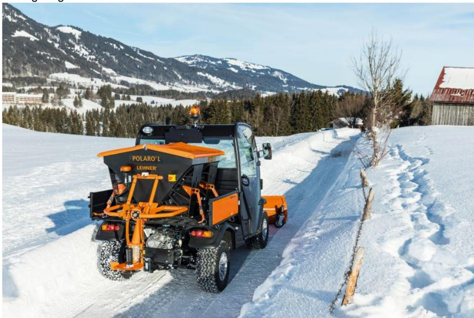
»Polaro L« mit 500 kg Fassungsvermögen auf RTV-Fahrzeug von Kubota (Bild: Lehner).
