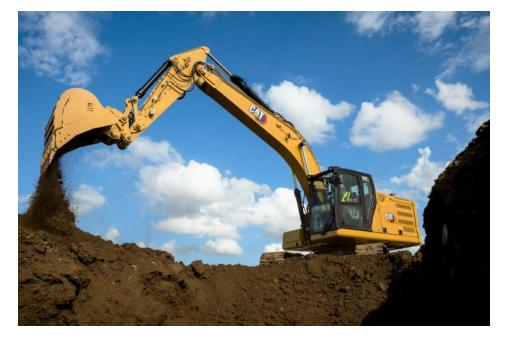
Prototyp auf der bauma: Kettenbagger »Cat 320 electric« mit 22 t Einsatzgewicht und 320 kWh-Batterie mit 600 V (Bild: Caterpillar/Zeppelin).
