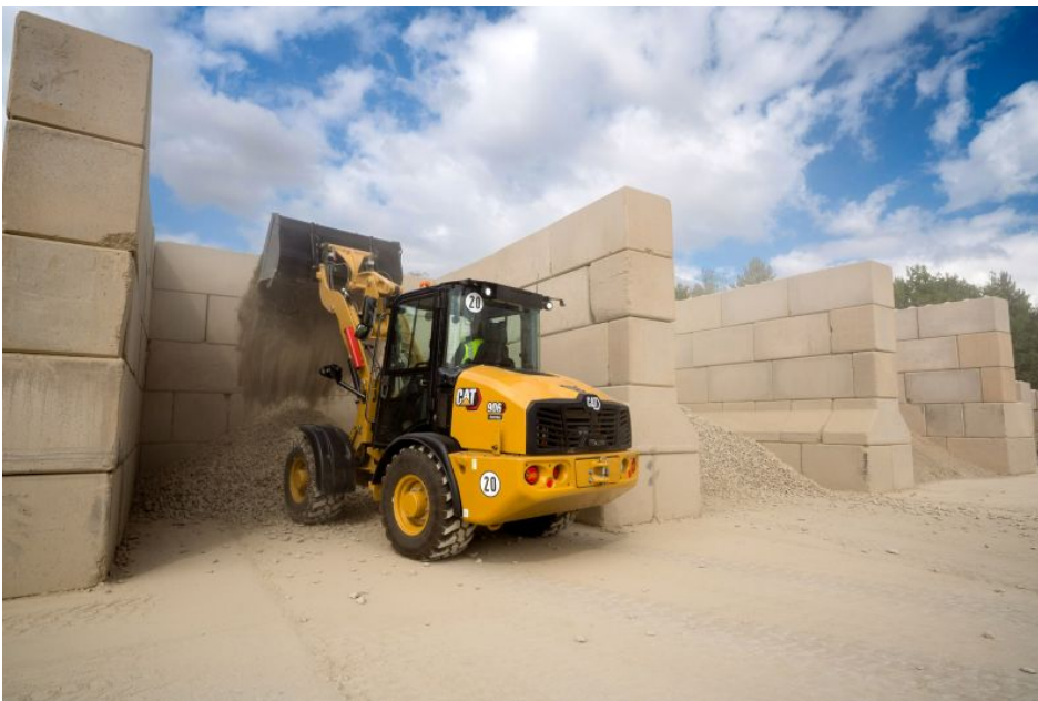
Prototyp des Radladers »Cat 906 electric« mit 6,2 t Einsatzgewicht und 64 kWh-Batterie mit 300 V (Bild: Caterpillar/Zeppelin).
