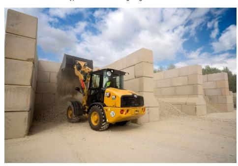
Prototyp des Radladers »Cat 906 electric« mit 6,2 t Einsatzgewicht und 64 kWh-Batterie mit 300 V (Bild: Caterpillar/Zeppelin).
