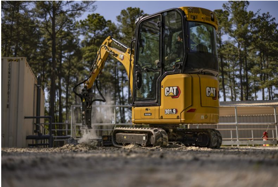
Prototyp auf der bauma: Cat Minibagger 301.9 electric mit fast 2 t Einsatzgewicht und 32 kWh-Batterie mit 48 V (Bild: Caterpillar/Zeppelin).
