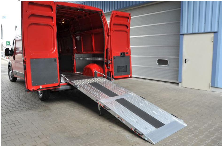
Verladeschiene Typ »RRK« hier als Sonderausführung mit Stützfuß und mittigem Korundbelag (Bild: Altec).
