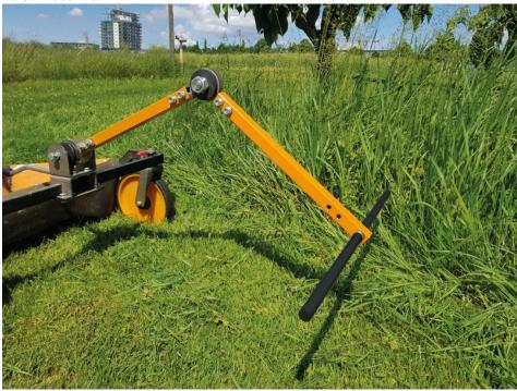
Die Scheuch-Vorrichtung von AS-Motor zum Schutz der Insekten bei der Mahd zeichnet sich durch ihre einfache Handhabung und Robustheit aus (Bild: AS-Motor).
