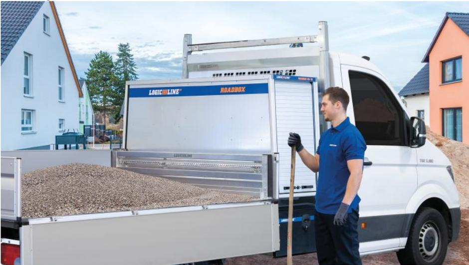
Der neue Ladeflächenteiler (vor der »Roadbox«) ist nur eines der nützlichen Zubehöerteile im umfangreichen LogicLine-Sortiment (Bild: LogicLine).
