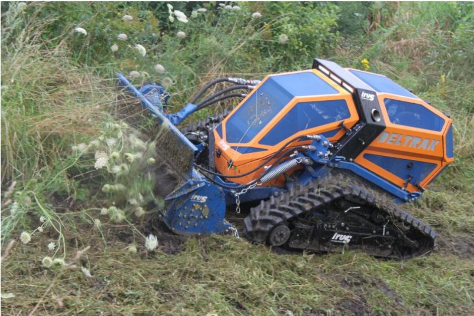
Der »Deltrak« im Mäheinsatz. Über ein umfangreiches Anbaugeräteprogramm ist der Geräteträger äußerst vielseitig einsetzbar (Bild: Irus).
