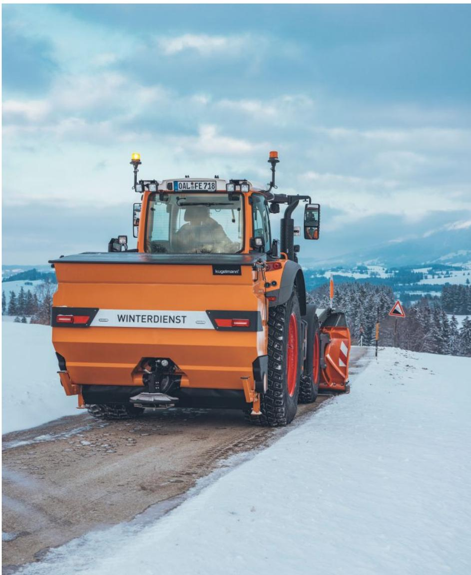
Die Streutellereinheit ist modular aufgebaut, damit Splitt, Salz und Sole jederzeit variabel ausgebracht werden können (Bild: Kugelmann).
