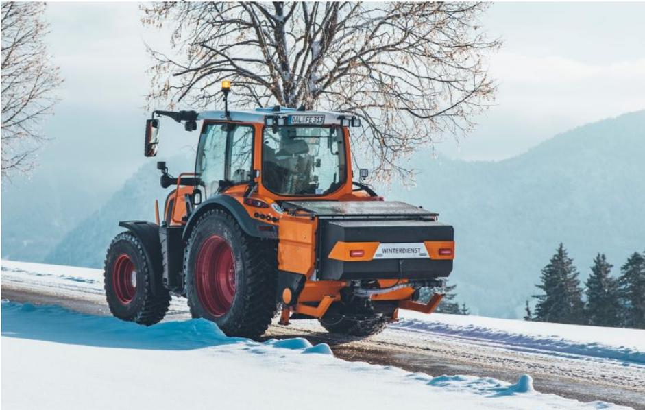
Die Kugelmann Dreipunktstreuer der »D«-Serie mit Zweikammersystem sind wahre Alleskönner (Bild: Kugelmann).
