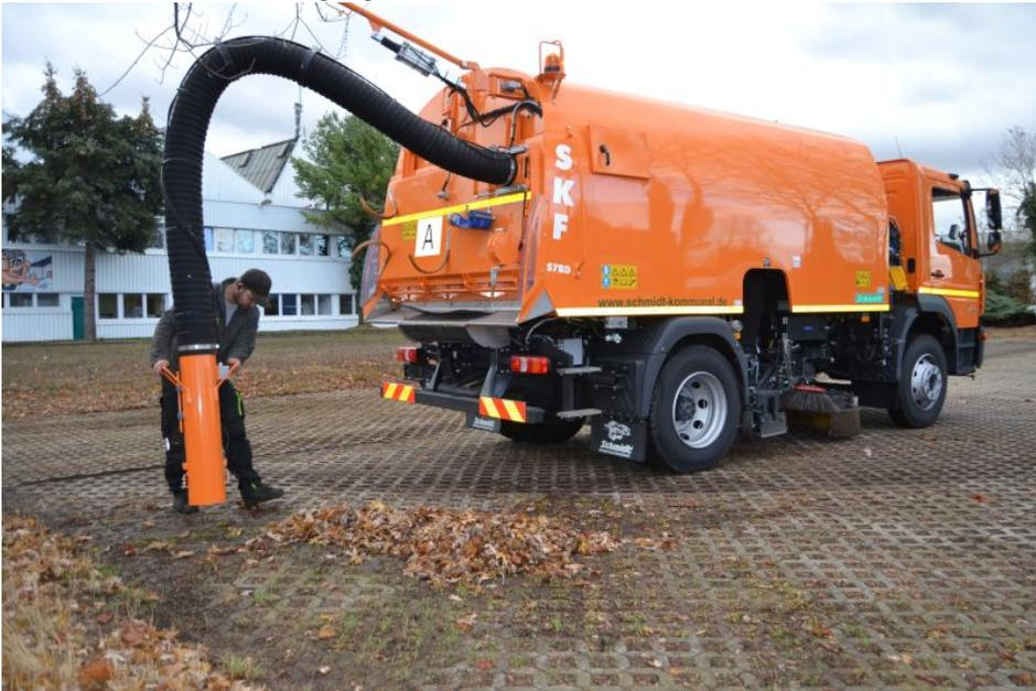
Mit dem leicht zu schwenkenden Saugrüssel wird das Laub effektiv aufgesaugt (Bild: SKF).
