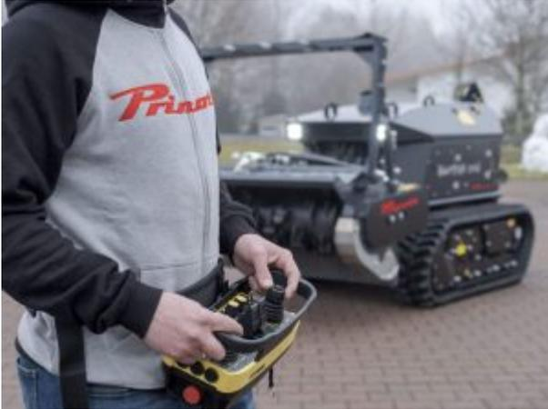
Die Sicherheit des Bedieners steht im Vordergrund – alle Funktionen sind über die ergonomische Funkfernsteuerung mit einer Reichweite von 100 m bequem zu bedienen.
