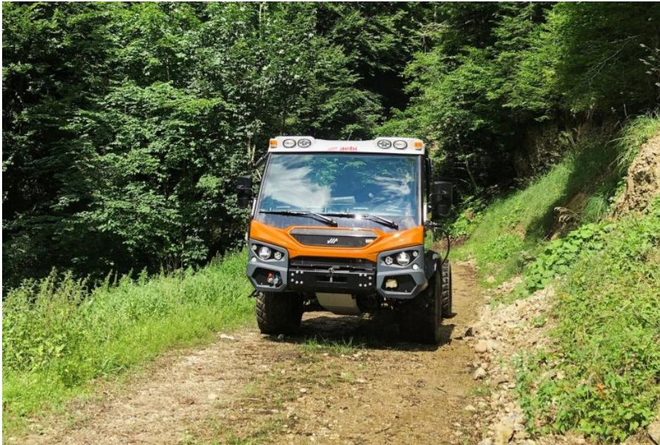
Stadt oder Land, Hauptsache Einsatzstärke: Mit 100 kW (136 PS) ermöglicht der optimierte Motor dem neuen »VM 470« eine Nutzlast bis zu 10 t (Bild: Aebi Schmidt).
