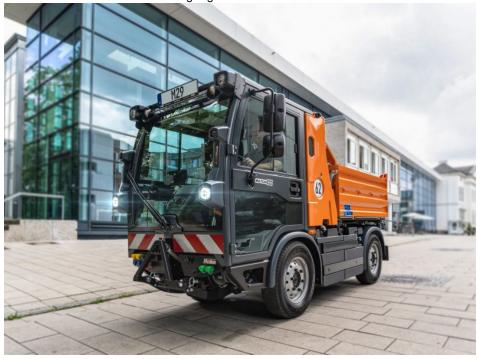
Der neue »Multicar M29« ist Geräteträger und Transporter in einem und mit 6,0 t zulässigem Gesamtgewicht auf den Ganzjahreseinsatz ausgelegt (Bild: Hako).
