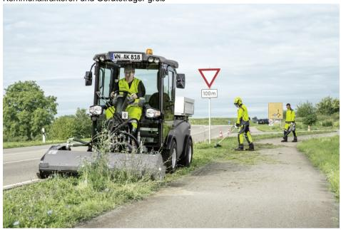
Die Saugkehrmaschine »MC 130 Plus« kann viel mehr als Straßenreinigung – dank Knicklenkung und starkem Fronthubsystem (Bild: Kärcher).
