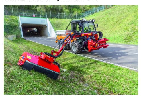
Für den schweren Einsatz gerüstet: Das Modell »S130« mit 129 PS starkem Stage-5-Motor (Bild: Kärcher Municipal).
