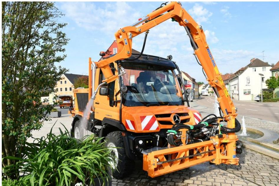
Ein »U 219« ausgerüstet mit einem Mulag Frontausleger mit Gießeinrichtung sorgt für rasche und wirkungsvolle Bewässerung des Stadtgrüns (Bild: Mercedes Benz Special Trucks).
