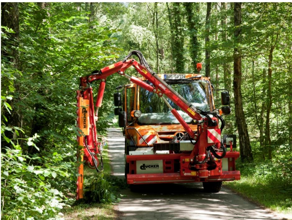
Grün oder orange – der »U 423« kann beides. Der Geräteträger hier im Einsatz mit Astschere der Firma Dücker (Bild: Mercedes-Benz Special Trucks).
