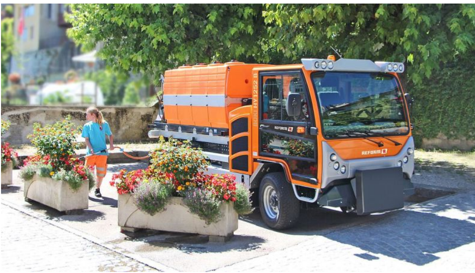
Ein hydrostatisch angetriebener »Boki HY 1252 B« mit Gießaufsatz (Bild: Reform-Werke).
