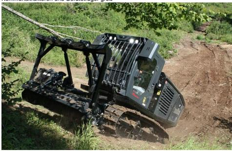
Der »Raptor 200« ist ein kompaktes und sehr leistungsfähiges Trägerfahrzeug – Arbeiten bis zu 45 Grad am Steilhang sind möglich (Bild: Prinoth).
