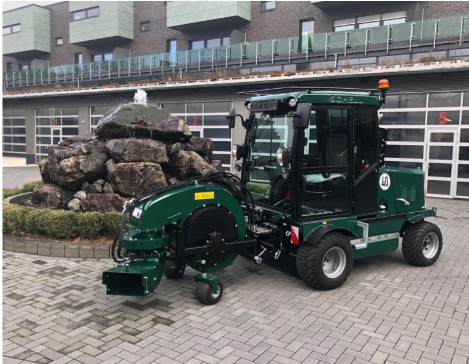
Der Geräteträger »SG 120« sorgt mit seinem hydraulischen Antrieb über vier Radmotoren mit optionaler Differentialsperrre für eine souveräne Arbeitsgrundlage (Bild: Schell).
