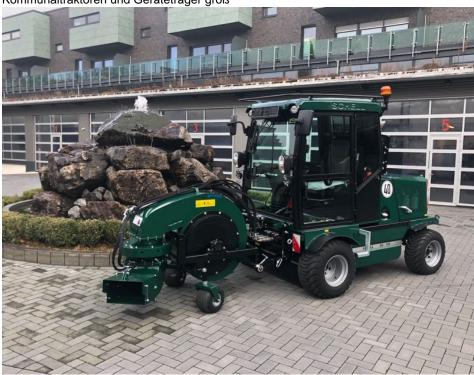
Der Geräteträger »SG 120« sorgt mit seinem hydraulischen Antrieb über vier Radmotoren mit optionaler Differentialsperre für eine souveräne Arbeitsgrundlage (Bild: Schell).
