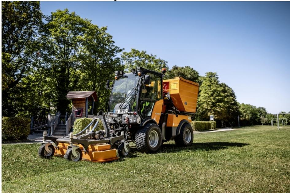
Der Holder »C 70« ist ein multifunktionaler knickgelenkter Geräteträger. Herzstück seines Fahrantriebs sind vier starke Radmotoren (Bild: Kärcher Municipal).
