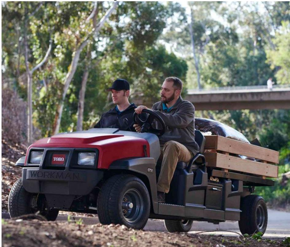
Toro hat mit dem »Workman GTX-E« ein preiswertes elektrobetriebenes Allzweckfahrzeug im Programm. Der Wechselstrom-Motor mit 48 V steht für Kraft und Leistung (Bild: Toro).
