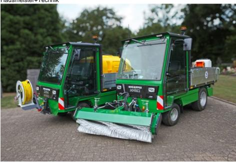
Hydrostatischer Fahrantrieb auf Radmotoren, Fahrautomatik und eine hydraulische Lenkung statten den »MK 2204« mit einer hervorragenden technischen Grundlage aus (Bild: Schmitz).
