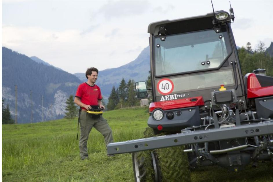
Bei Bedarf ist der Aebi »Terratrac« auch per Fernsteuerung kontrollierbar, was die Arbeitssicherheit z. B. auf unbekanntem oder militärisch genutztem Gelände erhöht oder in Extremlagen ermöglicht (Bild: Aebi Schmidt).
