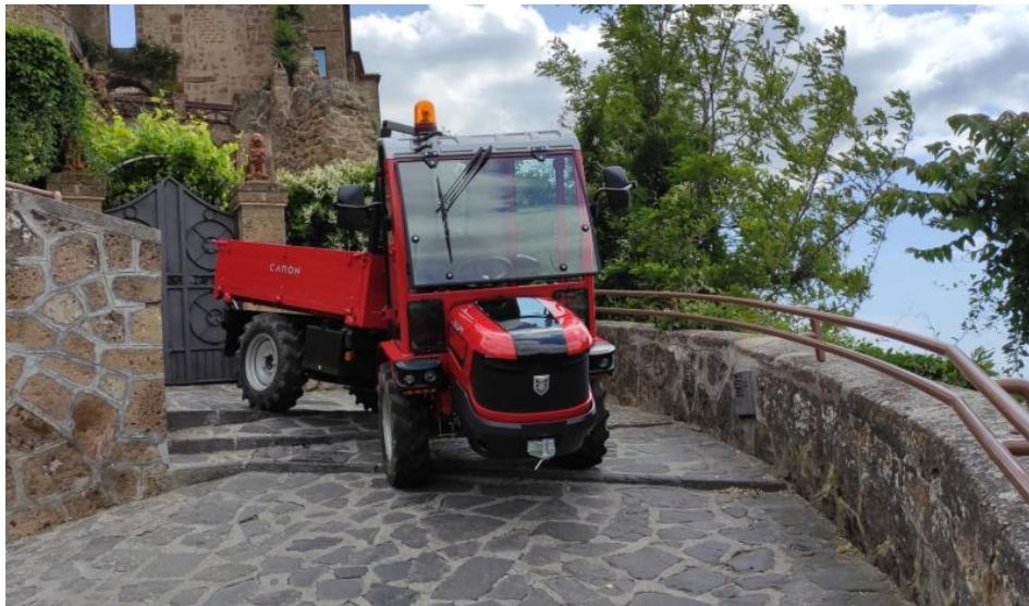
Caron bietet eine große Auswahl an Kleintraktoren mit Knicklenkung (AR) und Radlenkung (ST) an – hier der wendige »EVO 5 AR« (Bild: Caron).
