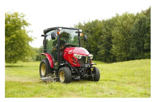
Der »YT3« steht für ein bewährtes Konzept mit i-HMT (Vario-Getriebe) und wahlweise 47 oder 60 PS (Bild: Yanmar Europe BV).
