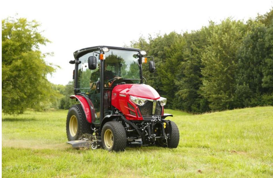
Der »YT3« steht für ein bewährtes Konzept mit i-HMT (Vario-Getriebe) und wahlweise 47 oder 60 PS (Bild: Yanmar Europe BV).
