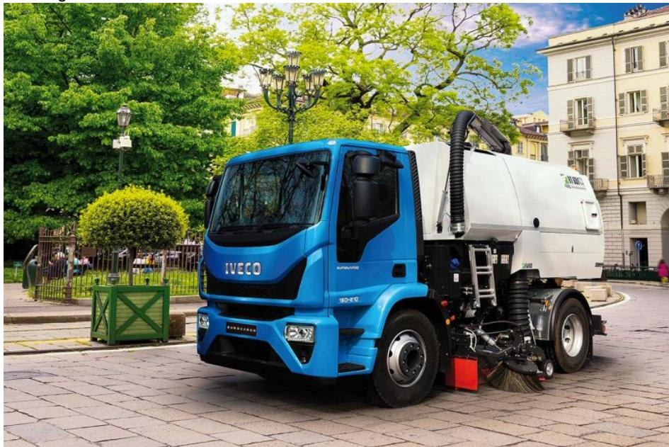
Der »EuroCargo« hat eine Fahrerhausbreite von gerade einmal 2,1 m – perfekt für den Einsatz in der City (Bild: IVECO Magirus).
