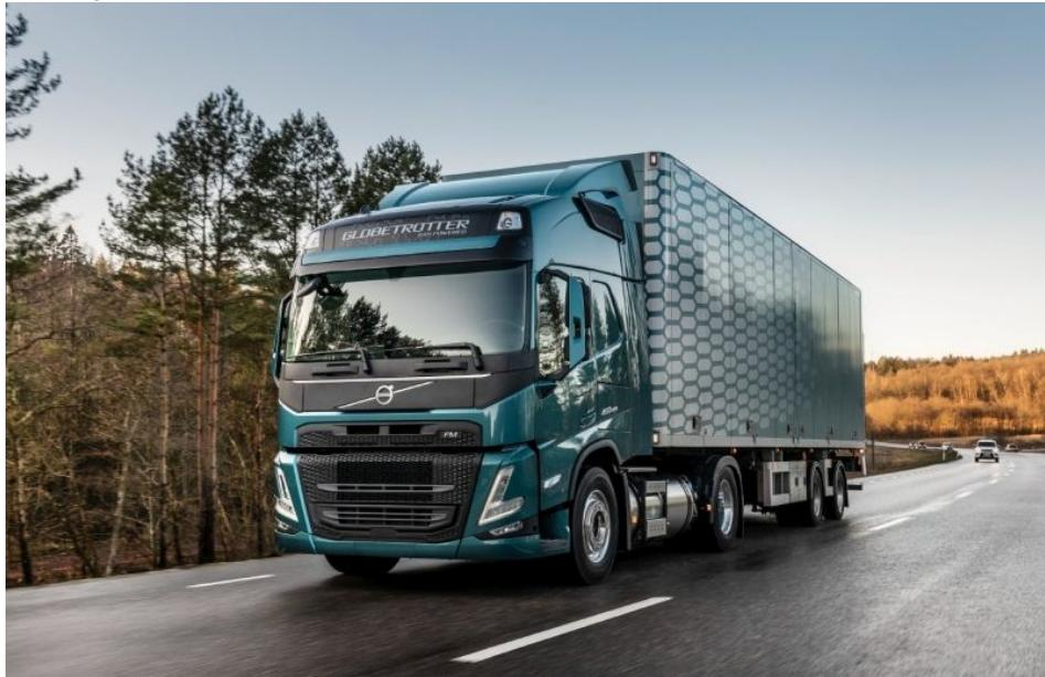
Gas-Pionier auf dem Markt der schweren Lkw: Der »Volvo FM LNG« ist mit 420, 460 oder 500 PS erhältlich (Bild: Volvo).
