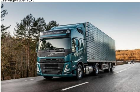
Gas-Pionier auf dem Markt der schweren Lkw: Der »Volvo FM LNG« ist mit 420, 460 oder 500 PS erhältlich (Bild: Volvo).
