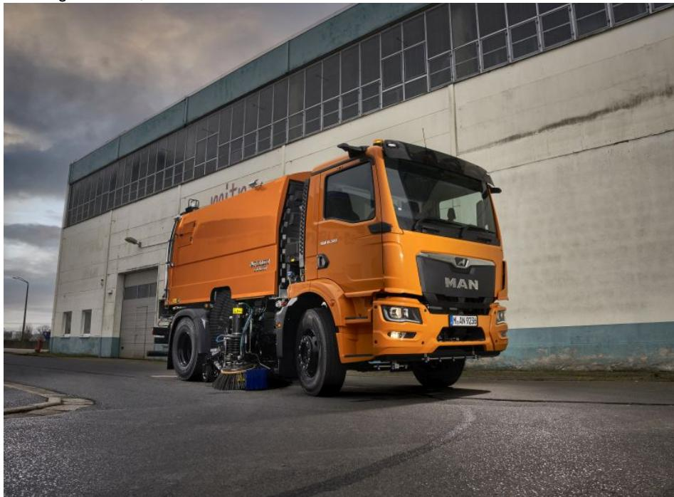
Eine kompakte Kombination stellt die Kehrmaschine aus »TGM 18.320« und »Faun Viajet 6«-Aufbau dar. Das elektronische Spiegelersatzsystem »OptiView« unterstützt den Fahrer, denn es bietet ihm beste Übersicht auf den Arbeitsbereich neben dem Fahrzeug (Bild: MAN).
