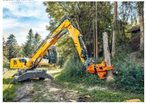
Die »Woodcracker CS 610 compact« ist für den Bagger mit 15-20 t Dienstgewicht vorgesehen. Die Fällgreifer hat einen Schneiddurchmesser von bis zu 610 mm (Bild: Westtech).
