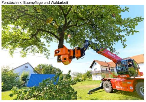
Die »Woodcracker CS smart« Greifersäge ist wegen ihres geringeren Gewichts speziell für den Anbau an Roto-Telelader vorgesehen, um eine möglichst hohe Reichweite erzielen zu können (Bild: Westtech).
