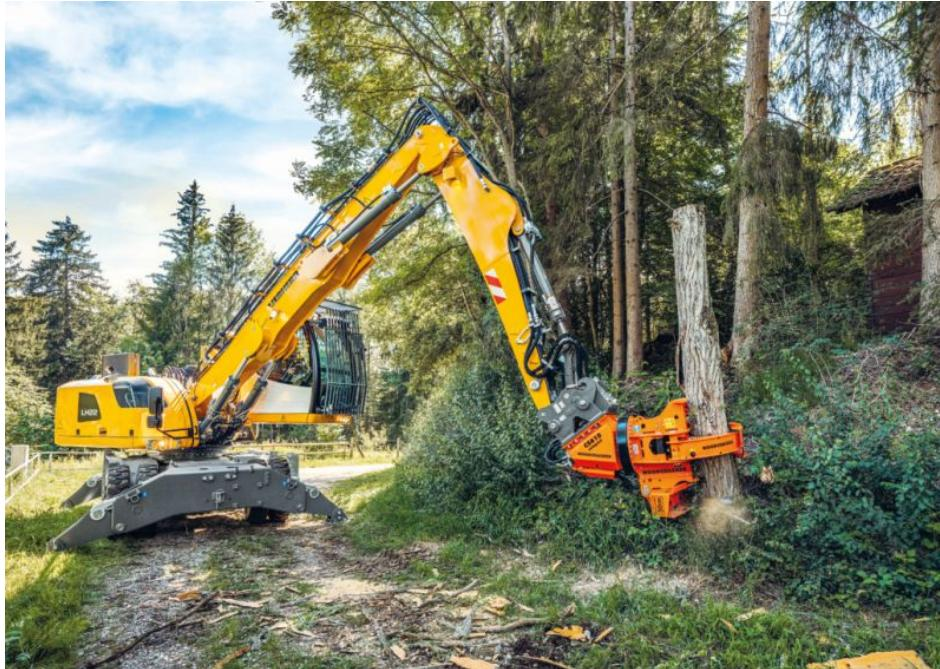
Die »Woodcracker CS 610 compact« ist für den Bagger mit 15 – 20 t Dienstgewicht vorgesehen. Die Fällgreifer hat einen Schnieddurchmesser von bis zu 610 mm (Bild: Westtech).
