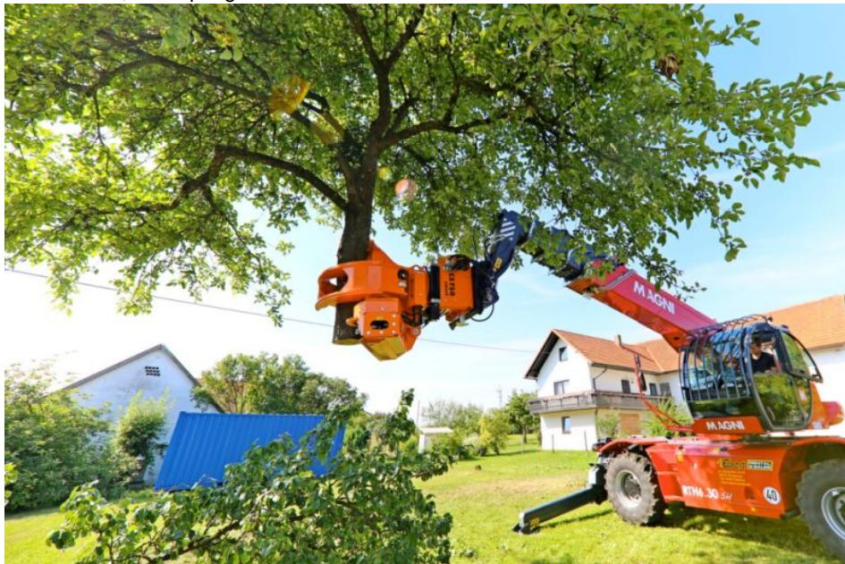
Die »Woodcracker CS smart« Greifersäge ist wegen ihres geringeren Gewichts speziell für den Anbau an Roto-Teleskopladern vorgesehen, um eine möglichst hohe Reichweite erzielen zu können (Bild: Westtech).
