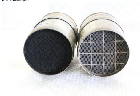
Der »verstopfte« Filtereinsatz ist nach der Behandlung befreit von Rückständen wie Ruß und Ascheablagerungen in den Kanälen. Die Reinigung spart bis zu 80% Kosten gegenüber einem Neukauf (Bild: DPF24).
