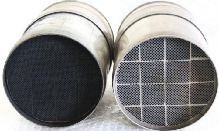
Der »verstopfte« Filtereinsatz ist nach der Behandlung befreit von Rückständen wie Ruß und Ascheablagerungen in den Kanälen. Die Reinigung spart bis zu 80% Kosten gegenüber einem Neukauf (Bild: DPF24).
