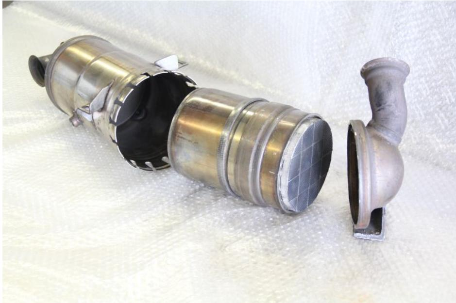
Das gereinigte Gehäuse sowie der Partikelfilter werden wieder montiert und DPF 24 gewährt eine 12-monatige Garantie auf dessen einwandfreie Funktion (Bild: DPF24).
