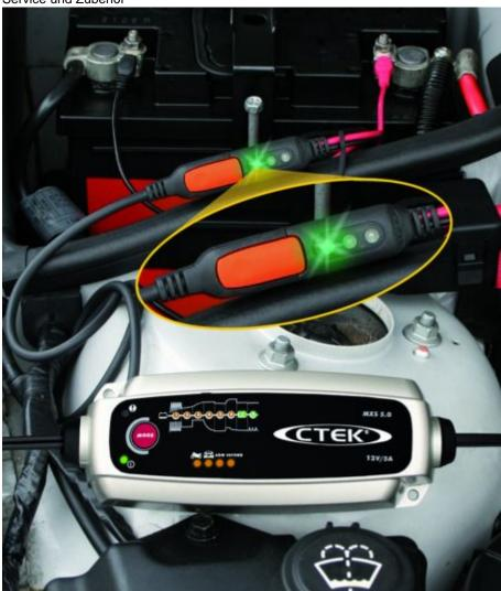
Regelmäßiges Laden der Starterbatterie bringt mehr Leistung und eine längere Lebensdauer (Bild: Kunzer).
