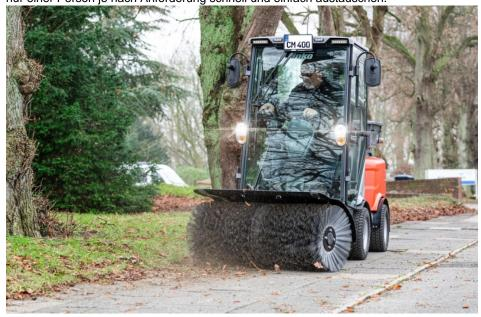
Ausgestattet mit verschiedenen An- und Aufbaugeräten meistert der »Citymaster 400 « fast jede saisonale Aufgabe. Das Schnellwechselsystem ermöglicht einen einfachen, werkzeuglosen und rückenschonenden Gerätetausch (Bild: Hako).
