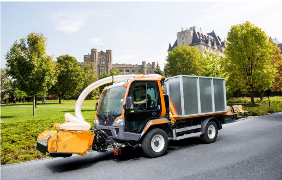
Ein »Unitrac 112 LDrive« mit Frontkehrwalze von Fiedler und Absaugung in einen Sammelbehälter auf Wechselrahmen Bild: Lindner.
