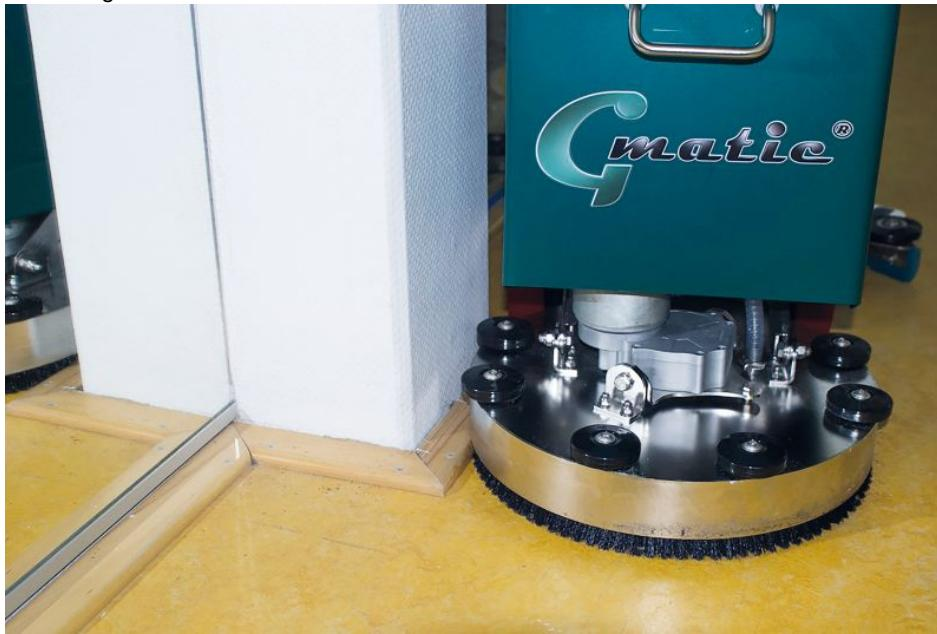
Der leichte Überstand des Bürstenkopfes und der schwenkbare Saugfuß ermöglichen eine randnahe Fußbodenreinigung. Ein manuelles Nacharbeiten entfällt (Bild: Dr. Gnansow).
