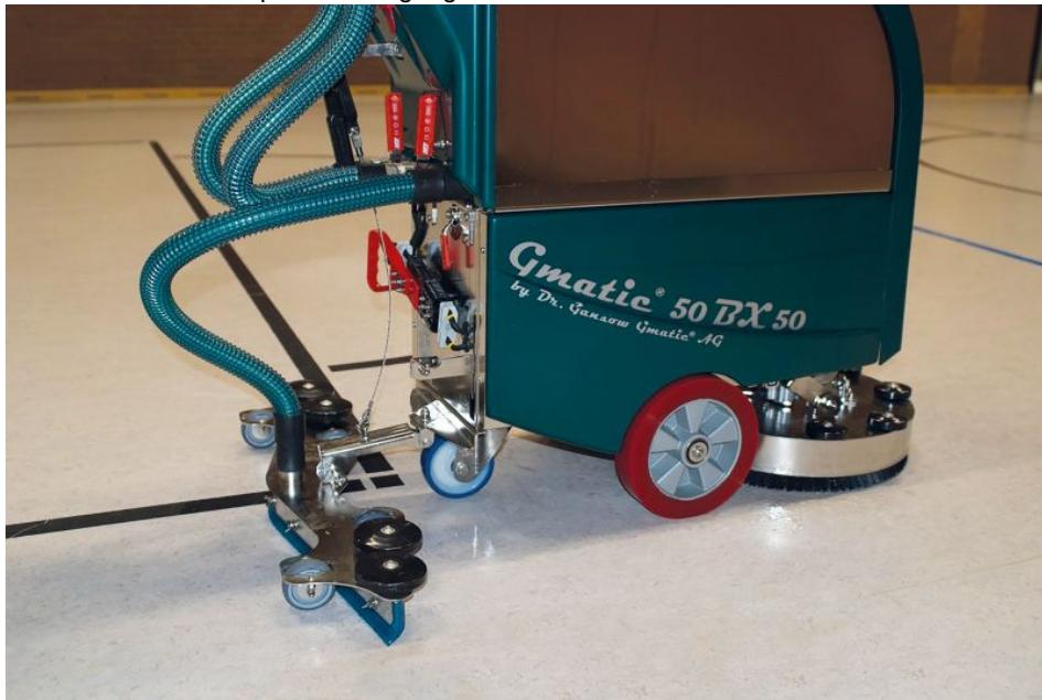
Die kompakte Scheuersaugmaschine »50BX50« gewährleistet hygienische und rutschsichere Fußböden in Sozialräumen (Bild: Dr. Gansow Gmatic).
