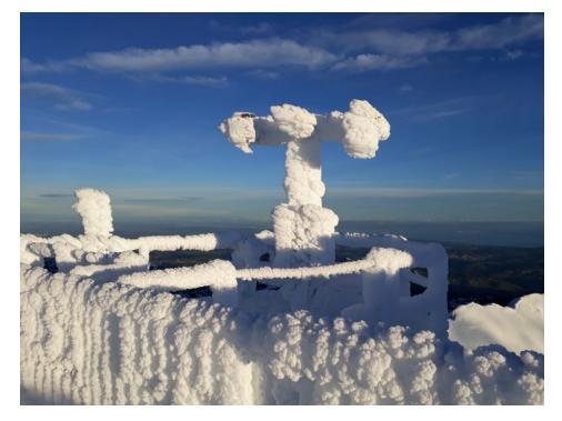
Die Wettermessstation (unten) wurde vom Eis stillgelegt (Bild: Säntis-Schwebebahn AG).
