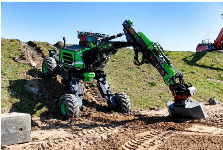
Mit der speziell von Makineo konfigurierten Leica-Maschinensteuerung lässt sich auch in extremen Schräglagen das Gelände plangerecht modellieren (Bild: Fallert).
