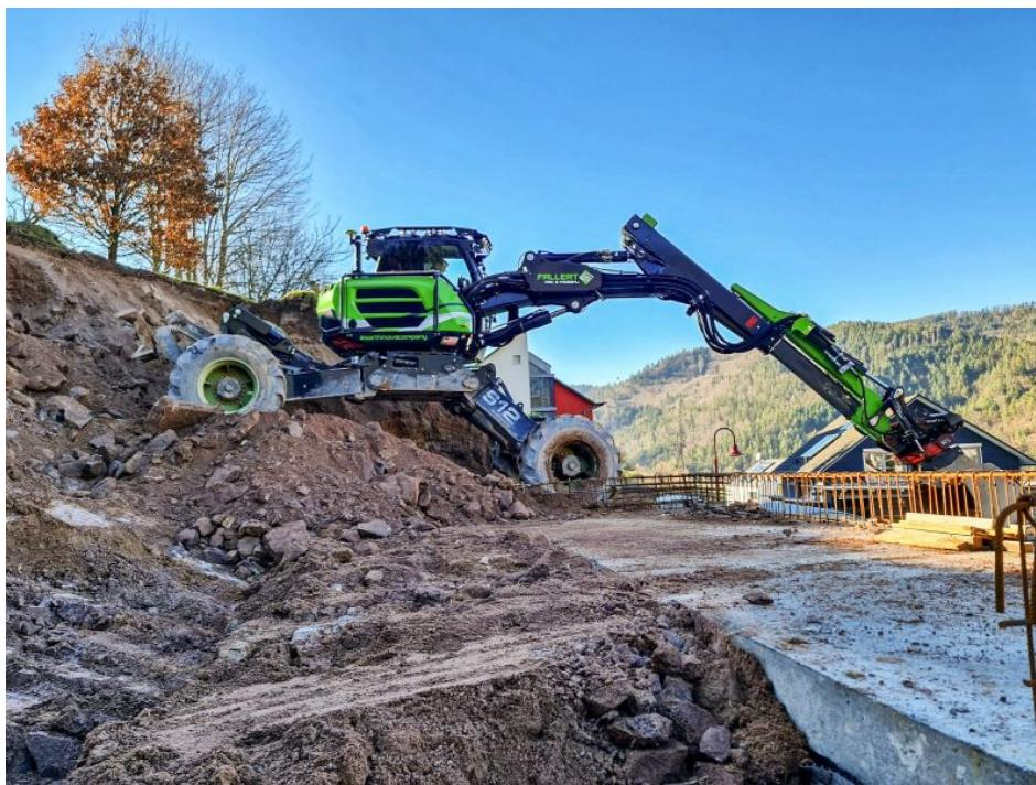
Für umweltschonende Erdarbeiten in schwer zugänglichem Gelände ersetzt die »Leica iCON iXE3«-Maschinensteuerung den direkten Blick (Bild: Fallert).
