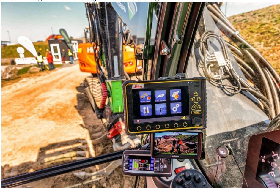
Blick ins Führerhaus und auf das Display der Maschinensteuerung (Bild: Fallert).
