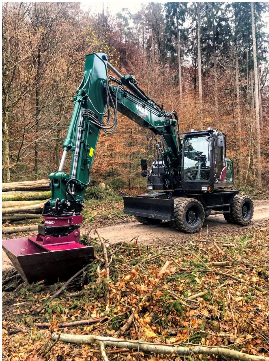
Variolöffel am »RotoTop«. Holp entwickelte den Löffel mit zwei Öffnungen für die Grabenreinigung und Bankettbearbeitung (Bild: Holp/wyynot).
