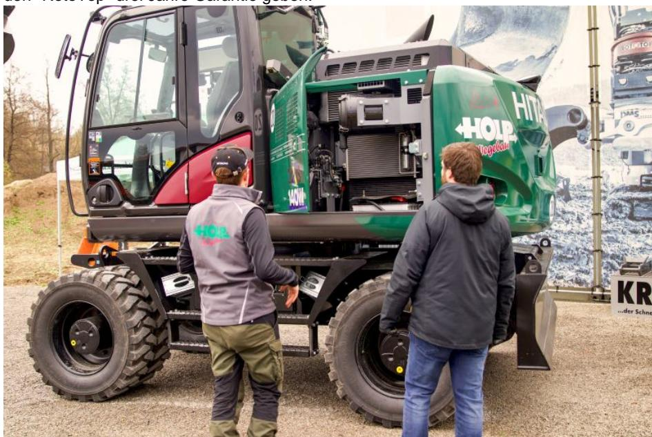
Alle Wartungspunkte sind beim »ZX140W-6« vom Boden aus über die aufklappbare Motorhaube erreichbar (Bild: Holp/wynot).
