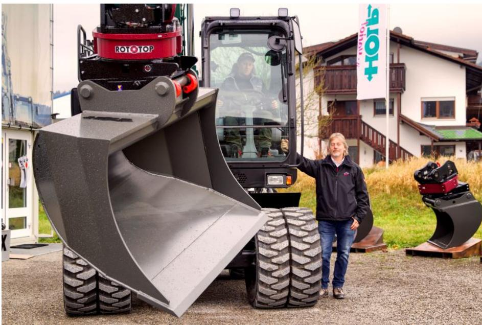
Variolöffel am »RotoTop«. Holp entwickelte den Löffel mit zwei Öffnungen für die Grabenreinigung und Bankettbearbeitung (Bild: Holp/wynot).
