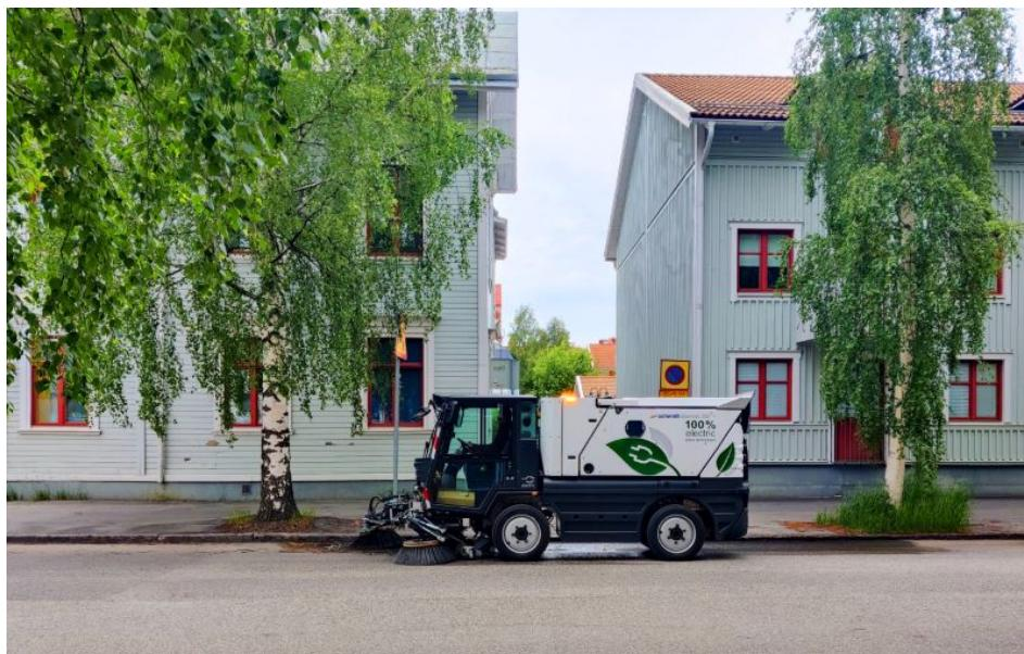
Der neueste Zugang in der »Swingo«-Baureihe ist das vollelektrische Kehrfahrzeug »eSwingo 200+« (Bild: Aebi Schmidt).
