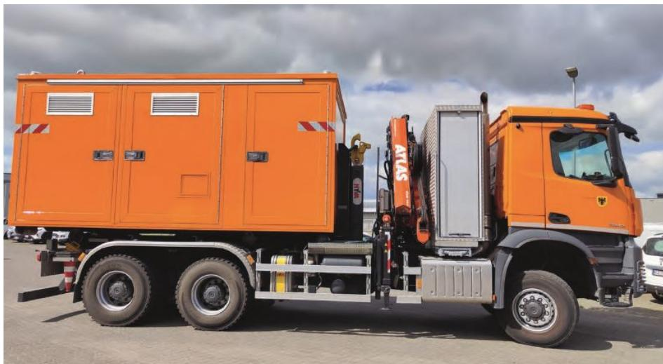
Der Notfallpumpencontainer lässt sich mit einem Lkw unkompliziert zum Einsatzort transportieren – etwa von einem Betriebshof aus (Bild: SubTech).
