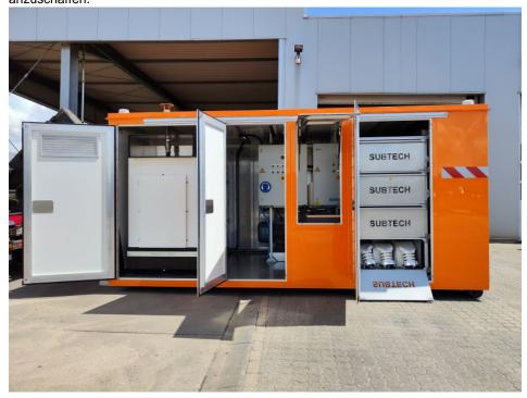
Der Container ist voll ausgestattet, unter anderem mit einer Drehkolbenpumpe, einem Stromgenerator, geeigneten Schläuchen und einer Werkbank im Inneren (Bild: SubTech).
