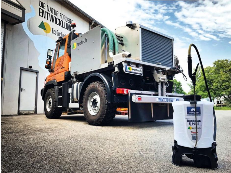
Die »IceFighter«- Familie reicht vom möglichen 8000-l-Tank bis zum handlichen Backbag – dem Solesprüher für den Rücken. Mit dem Backbag können Stiegenaufgänge oder kleine Hauseinfahrten schnell eisfrei gehalten werden (Bild: Eco Technologies).
