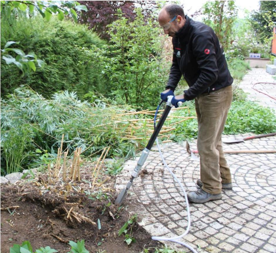
Der Vogt TurboSpaten »VTS« bricht z. B. Erdschichten leichter auf oder verdichtet mit entsprechenden Aufsätzen. (Bild: Vogt).
