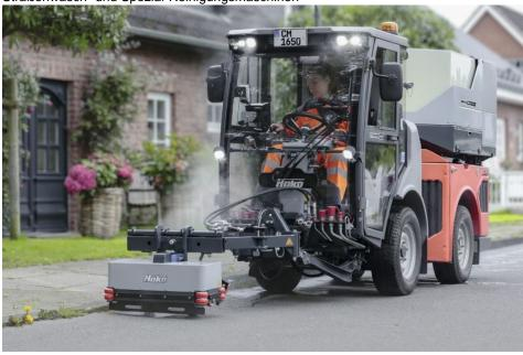
Das Wasserstrahlsystem »Weco M900 City« liefert eine Heiß- und Kaltwasser-Hochdruckreinigung, Wildkrautentfernung und Bewässerung in einem Gerät (Bild: Hako).
