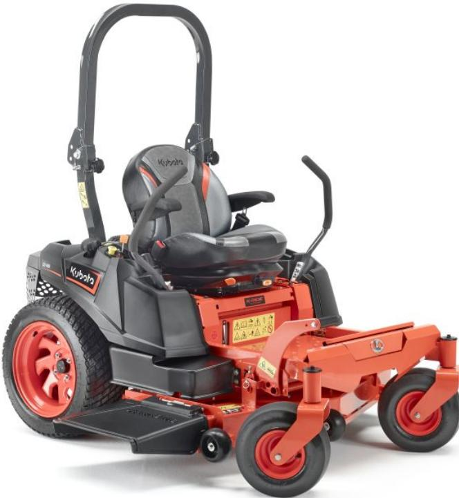
Zusammen mit dem Anschallgurt gewährleistet der ROPS-Überrollschutz die Bedienersicherheit beim Arbeiten am Hang.
