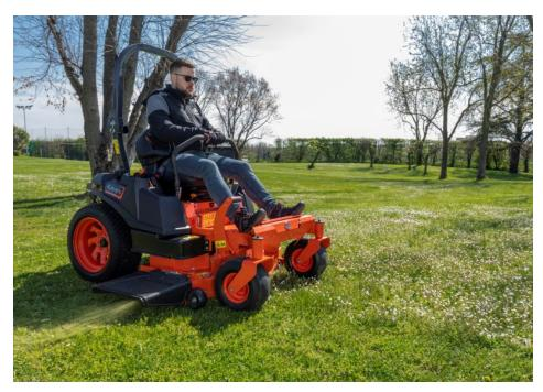
Der Nullwendekreismäher »Z2-481« hat alles, was für eine effiziente und komfortable Grundstückspflege dazugehört. Mit dem K-Lift-Pedal kann der Fahrer das Mähdeck anheben und absenken, ohne die Hände von den Bedienelementen zu nehmen (Bild: Kubota).
