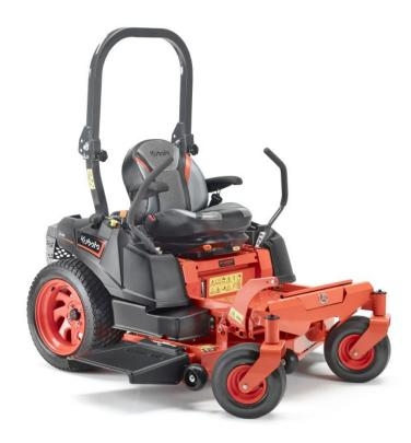
Zusammen mit dem Anschnallgurt gewährleistet der ROPS-Überrollschutz die Bedienersicherheit beim Arbeiten am Hang.
