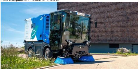
Die neue »Cleango 550« ist auch mit elektrischen Antrieb verfügbar und besitzt ein Systemvolumen von 5,5 m³ (Bild: Aebi Schmidt).
