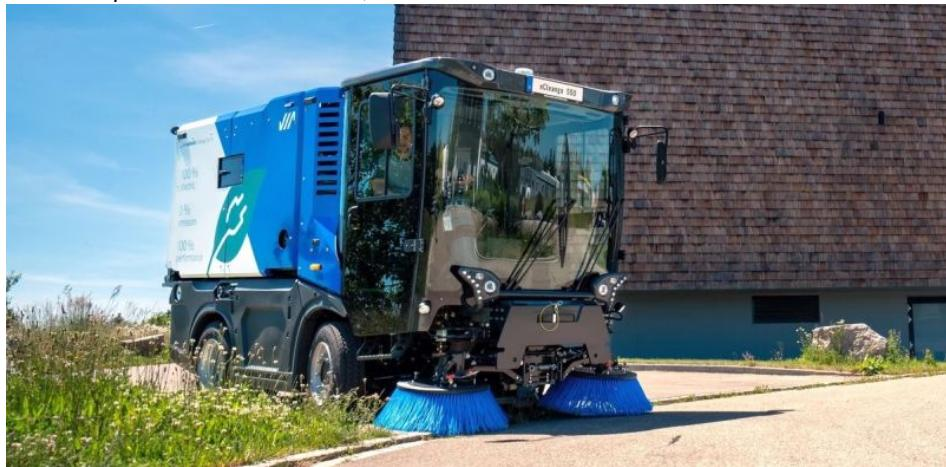
Die neue »Cleango 550« ist auch mit elektrischen Antrieb verfügbar und besitzt ein Systemvolumen von 5,5 m<sup>3</sup> (Bild: Aebi Schmidt).
