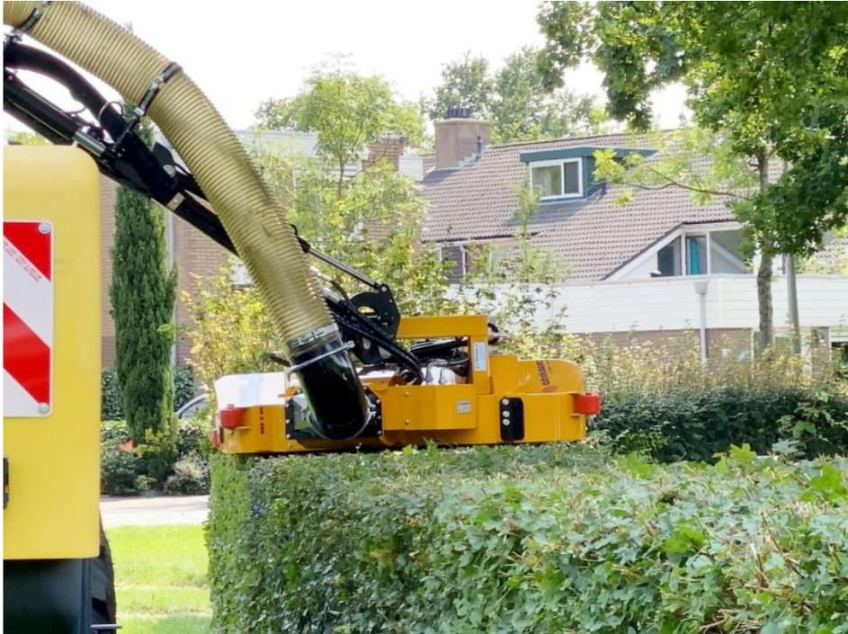
Auf den Heckenmulcher wird eine Häckseinheit montiert. Diese wird hydraulisch und zusammen mit dem Mähwerk angetrieben, wodurch beide stets synchron laufen.
